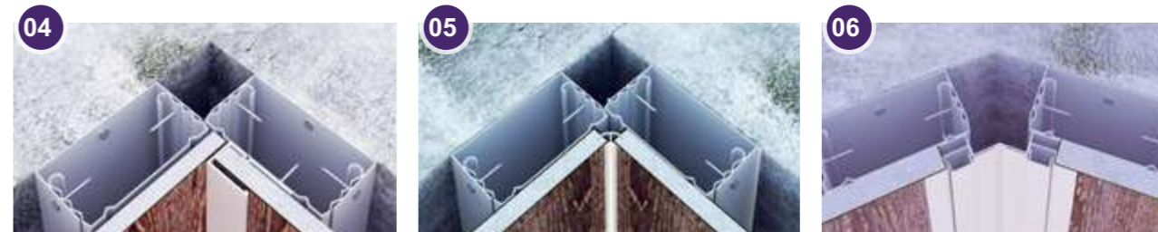
04 Монтаж угла 90° с использованием углового профиля
