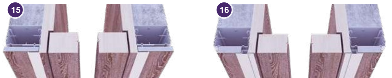
15 Монтаж с использованием L - профиля
